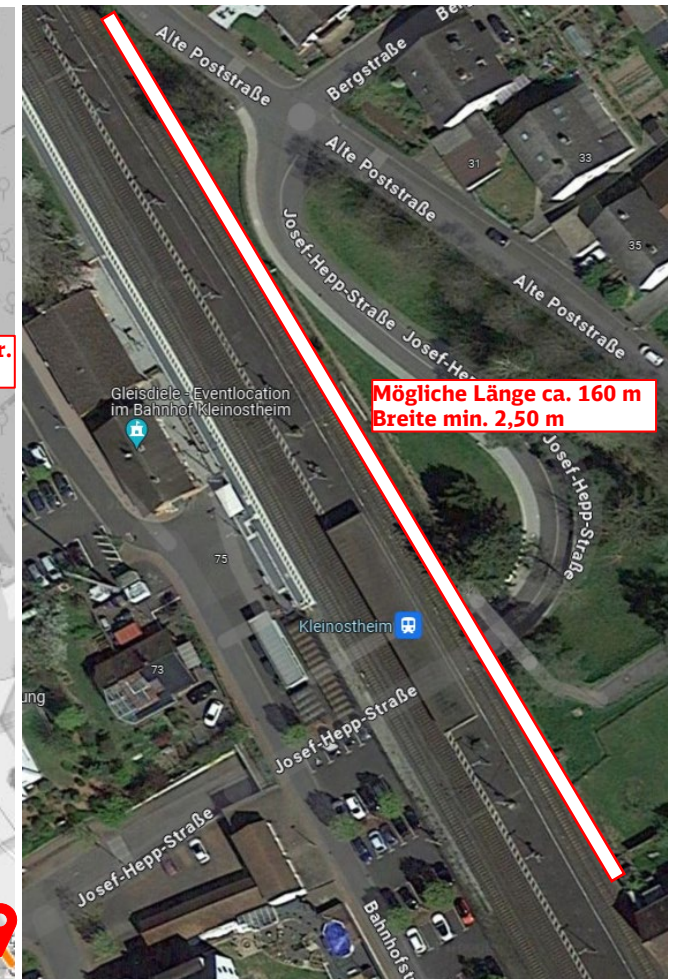
Möglicher Außenbahnsteig für barrierefreie Erschließung Bf Kleinostheim
