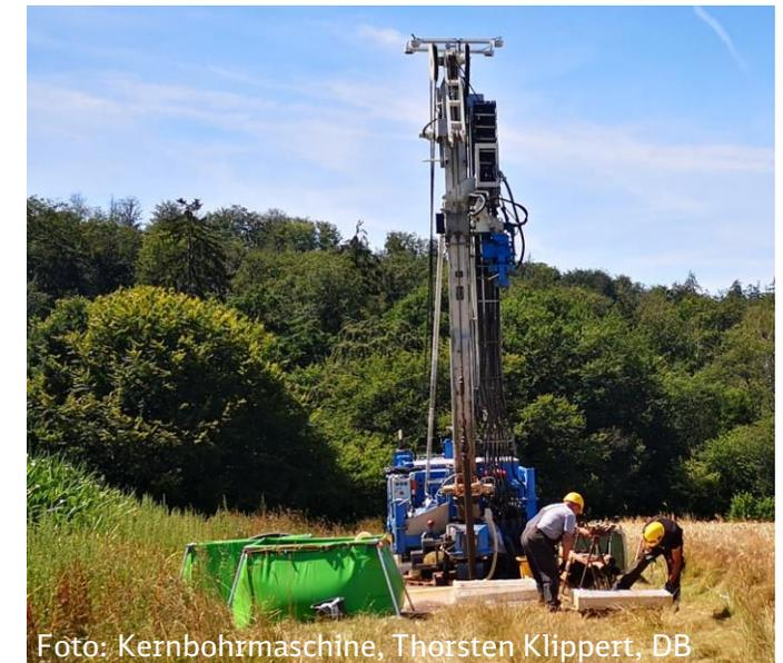
Foto: Kernbohrmaschine, Thorsten Klippert, DB
